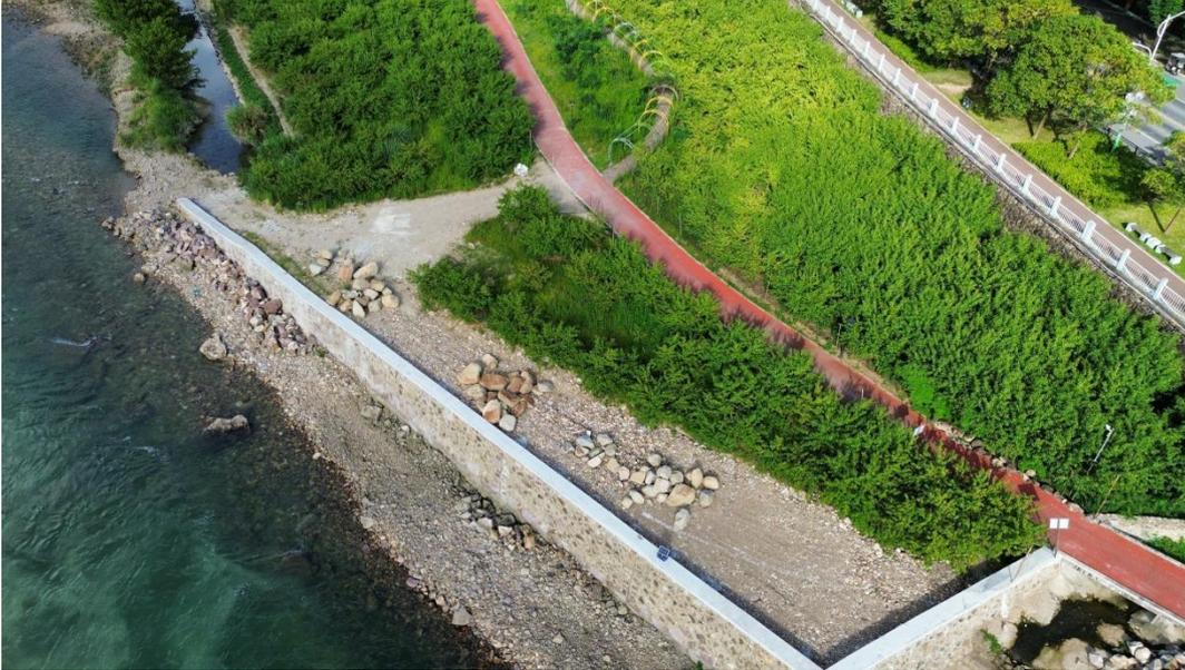
图 2.3.14 护岸施工期临时堆料场位置（已恢复）
